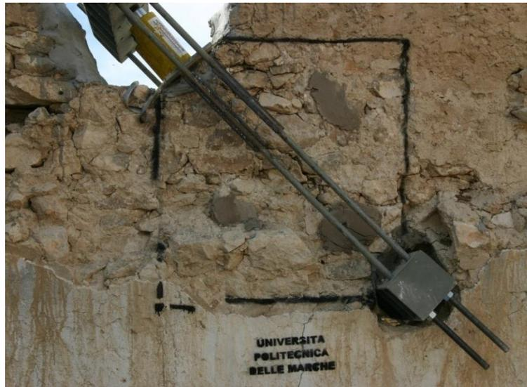
Prova in situ di compressione diagonale
