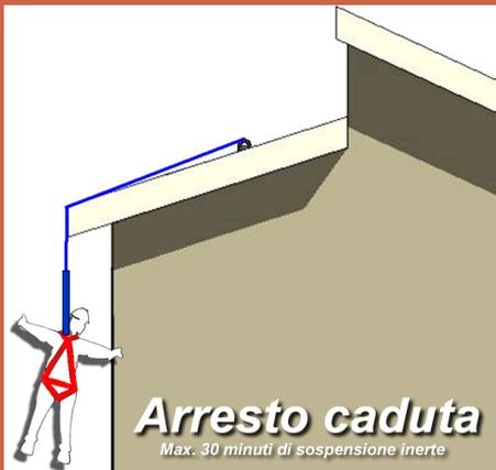
Malgrado i sistemi di arresto, le conseguenze di una caduta sono spesso gravi. La **sospensione inerte** in una qualsiasi imbracatura, può provocare gravi disturbi fisiologici dovuto alla compressione dei vasi degli arti inferiori e al conseguente disturbo del ritorno di sangue venoso.
