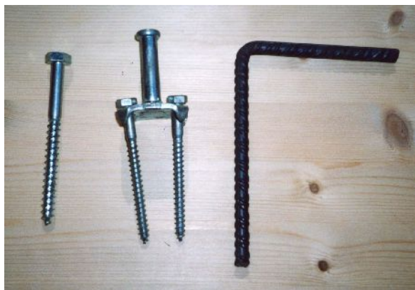
Connettori per solai con soletta collaborante, da sinistra: vite mordente, connettore Tecnaria Base, connettore Turrini-Piazza.
