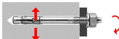
\* L'installazione induce tensioni sul materiale
