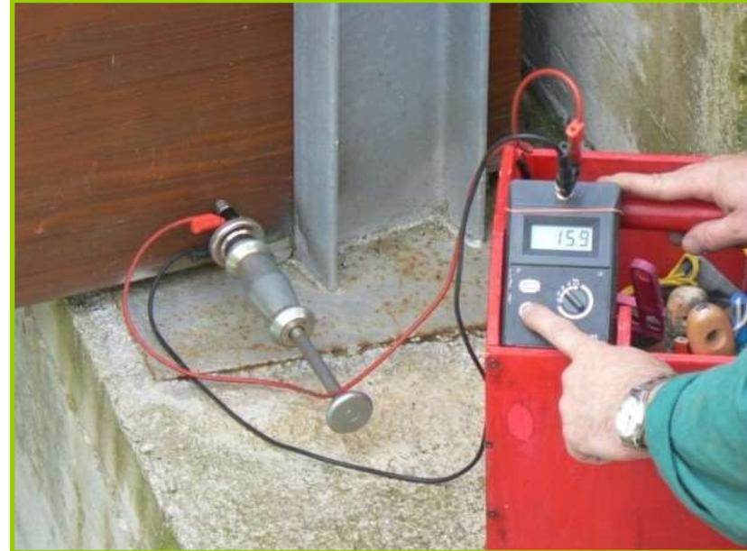
L'umidità del legno si può misurare in cantiere per mezzo degli igrometri elettrici, apparecchi che misurano la resistenza elettrica fra due elettrodi (chiodi) infissi nel legno la quale è correlata con l'umidità del legno.
