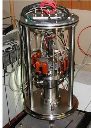
Vengono applicate sollecitazioni torsionali cicliche utilizzando un sistema elettromagnetico che genera una coppia oscillante in corrispondenza della base superiore del provino. Ripetendo la prova con diversi valori di forzante è possibile ricostruire la variazione della risposta in funzione della deformazione del provino.
