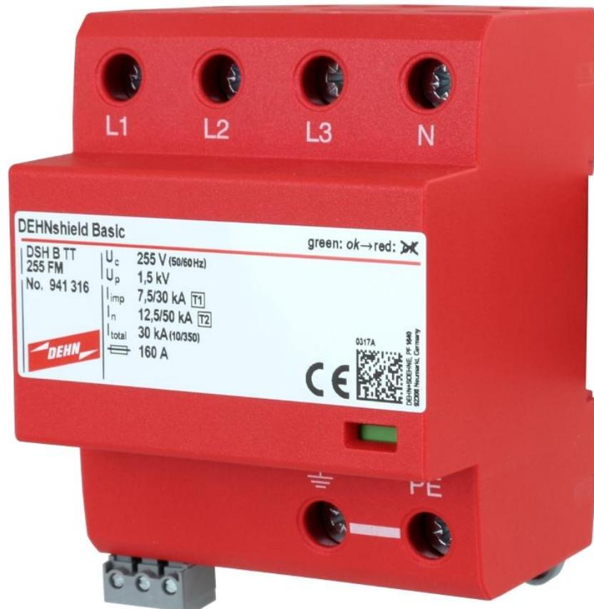
**DEHNshield® Basic**, con la sua capacità di scarica 7,5 kA (10/350), supera ampiamente i requisiti minimi previsti dalla nuova norma, andando oltre i criteri di protezione introdotti dalla CEI 64-8; V5 in tutte le sue possibili applicazioni.
