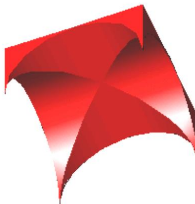
b) Volta a crociera V_c = 5,99 \text{ mc}
